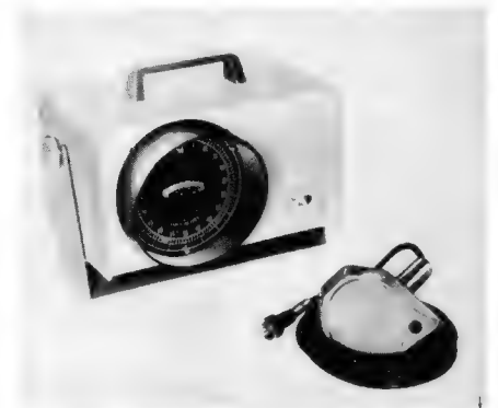
Bild 1. Echolot für Batteriebetrieb. Anzeige 0 bis 100 Fuß (= 0...30,5 m) Wassertiefe. Vorn der Bariumtitanat-Schallwandler im Kunststoffgehäuse (Modell Depth Sounder MI-10 von Heath)
