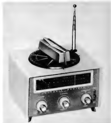
Bild 11. Kleiner Funkpeiler mit drei Wellenbereichen, Transistorbestückung und Batteriebetrieb (Modell MR-11 von Heath)
