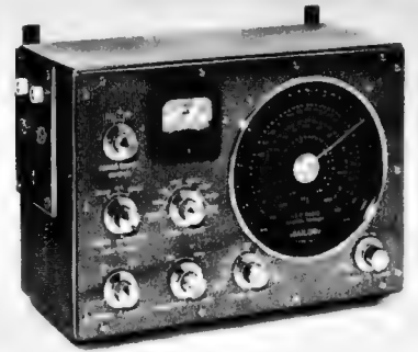
Bild 15. Universal-Empfänger mit Peilzusatz und Transistorbestückung für Bordbetrieb (Modell Sailor 16 T von A/S S. P. Radio)
